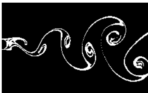
Tourbillons dits de « von Karman » qui se produisent systématiquement en aval des piles d'un pont lorsque la puissance du courant est adaptée à leur formation
