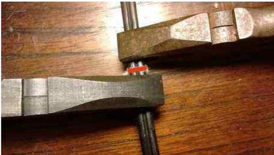
Retorcer media vuelta el cable, por ejemplo utilizando dos pinzas. Cada pinza debe estar separada aproximadamente a 2 mm de la marca, para que el punto de cruce de ambos conductores después de la torsión quede exactamente donde pusimos la marca. Es decir, entre la soldadura y el punto de cruce hay 32,7 cm. En realidad la torsión resta unas décimas de milímetro en la longitud y la distancia puede quedar en 32,5 cm, sin problemas.
