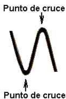
Sin los pliegues, la longitud de la antena sería casi 1 m . Con los pliegues es 32,7 cm (más lo que mida el conector).
