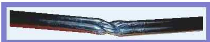
Los conductores intercambian sus posiciones en la torsión de media vuelta. El conductor que en la parte izquierda de la foto está arriba, queda abajo en la parte derecha de la foto. El conductor que en la parte izquierda de la foto está abajo, queda arriba en la parte derecha de la foto.
