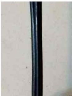
Para trabajar cómodamente, tomamos un tramo de 1,10 m de cable bifilar telefónico. Es el cable que encontramos abandonado en la vía pública, aislación en plástico negro, resistente, con 4,2 mm de separación entre ambos conductores aproximadamente.
