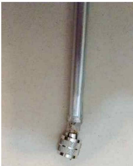
El tubo se desliza sobre el irradiante. La posición del tubo influye en el rendimiento de la antena. Antes de inmovilizar el tubo para asegurar su posición, necesitaremos buscar la posición donde el rendimiento es óptimo. Después de eso lo inmovilizaremos.
