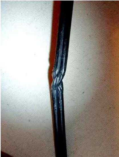
Los conductores intercambian sus posiciones en la torsión de media vuelta. El conductor que en la parte superior de la foto está a la izquierda, pasa a la derecha después de la torsión. El conductor que en la parte superior de la foto está a la derecha, pasa a la izquierda después de la torsión.
