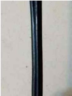
Para trabajar cómodamente, tomamos un tramo de 30 cm de cable bifilar telefónico. Es el cable que encontramos abandonado en la vía pública, aislación en plástico negro, resistente, con 4,2 mm de separación entre ambos conductores aproximadamente.
