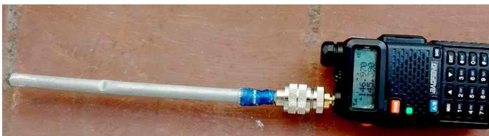
Sin el tubo la antena funciona, pero rinde menos. En caso de no disponer de un tubo, el rollo de aluminio de cocina puede ser utilizado para un envoltorio metálico, que no tiene las ventajas del tubo, pero es mejor que nada.
