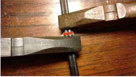
Exactamente donde está la primera marca retorcer media vuelta el cable, por ejemplo utilizando dos pinzas. Cada pinza debe estar separada aproximadamente 2 mm de la marca, para que el punto de cruce de ambos conductores después de la torsión quede exactamente donde pusimos la marca. Es decir, entre el punto de cruce de la torsión y la soldadura hay 52 mm , medidos como ha sido indicado previamente.
