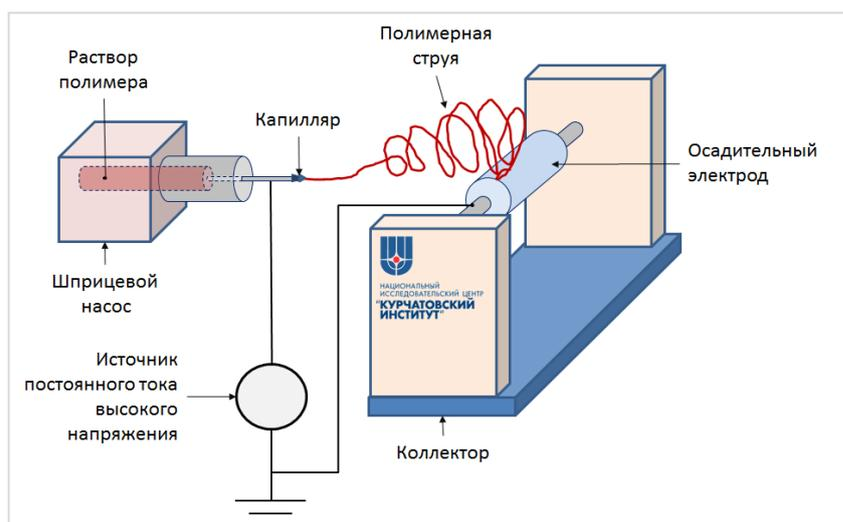
Рисунок 2.2 Схема установки электроформования полимерных волокон для создания каркасов ТИК в лаборатории полимерных материалов НИЦ «Курчатовский институт»
