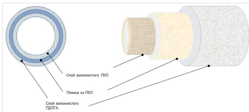
Рисунок 2.3 Схема многослойной структуры композитного каркаса ТИК желчного протока в составе слоя волокнистого ПКЛ, ПКЛ-пленки и слоя волокнистого ФДЛГА
