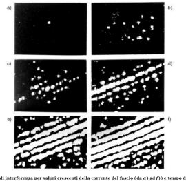
Fig. 2. – Frange di interferenza per valori crescenti della corrente del fascio (da a) ad f)) e tempo di registrazione costante. Si osservano frange di interferenza anche con tempi molto lunghi di registrazione ed elettrone singolo passante.
