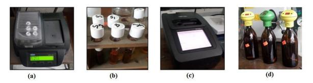
Figure 1: (a) COD Reactor, (b) COD Vial, (c) UV Spectrophotometer, (d) BOD Oxitop
