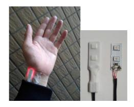
注:两个贴片红光 1ed (620-625nm, 0.2W, 2835) 串联后再串联一个电阻 (20 欧姆),用白色热缩管 (Ø6.0) 包覆,电源是 5V。用医用透气胶布粘贴在穴位上就可以了。
