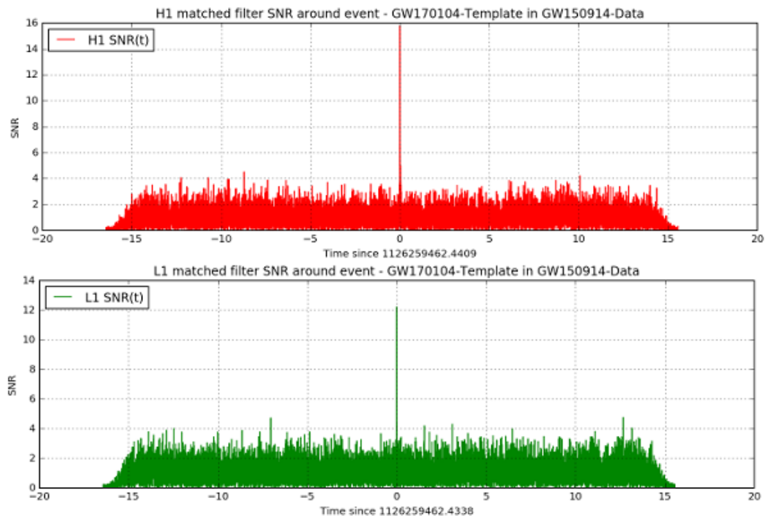
Abb. 2. Signal-Rauschen-Verhältnis nach dem Einsetzen von GW170104-Template in die Daten von GW150914.
