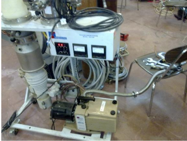
5- شکل پمپ خلاء سازی و دیفیوژن بکاررفته در فرایند خلاء سازی را نشان میدهد.
