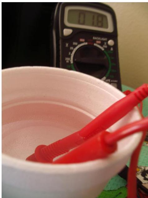
Рис.3. Применение электродов с одним цветом изоляции снижает разность потенциалов практически до нуля. Остаточная разность потенциалов может объясняться различием формы изоляции. Вольтметр показывает 1.8мВ.
