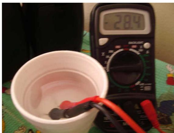
Рис.4. Применение электродов с одинаковой формой изоляции, но различного цвета, восстанавливает эффект. Вольтметр показывает -28.4мВ.
