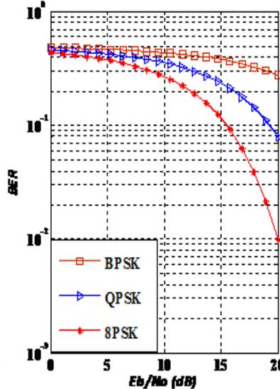
Fig. 5 b MB-OFDM UWB MIMO (2\*2)
