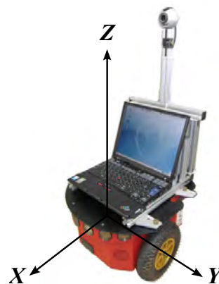
図 3: 移動ロボットの外観と座標系
