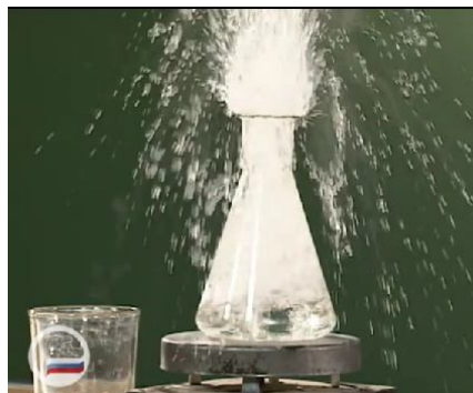
Рис.3. Перегретая жидкость. Вода в колбе была нагрета до температуры выше 100 градусов. Но она не закипела. После того, как лектор добавил в колбу щепотку мела, вода мгновенно взрывоподобно закипела. ( http://youtu.be/2dVJV_QC5pc )
