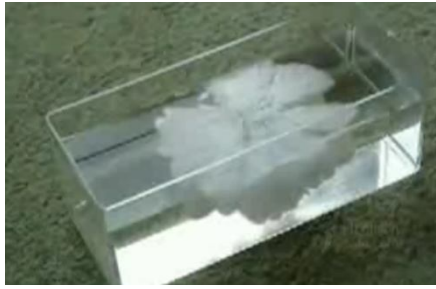
Рис.1. Как получить лед моментально? Кристаллизация переохлажденной воды в чашке. Автор фильма в предыдущих кадрах коснулся пальцем поверхности воды, после чего начался процесс образования льда в её толще. Закончился процесс замерзанием всей воды в чашке. ( http://youtu.be/2HX0OIDLlog )
