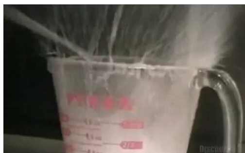
Рис.3. Перегретая жидкость. Вода в колбе была нагрета до температуры выше 100 градусов. Но она не закипела. После того, как лектор добавил в колбу щепотку мела, вода мгновенно взрывоподобно закипела. ( http://youtu.be/2dVJV_QC5pc )
