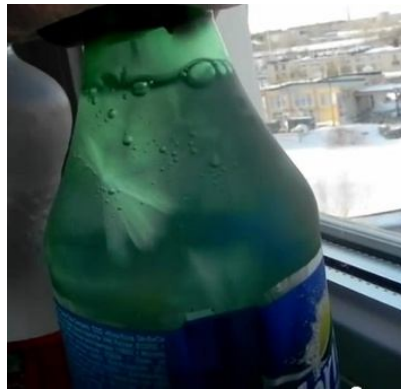
Рис.2. Моментальный лед. Кристаллизация переохлажденной воды в бутылке. Автор фильма в предыдущих кадрах ударил бутылку о подоконник, после чего за секунды вода в бутылке замерзла. ( http://youtu.be/Q3Bwo5BGyoY )
