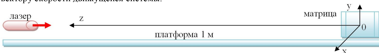
Рис.12 Схема галактического панорамного спидометра. Лазер и матрица жестко закреплены на платформе, которая закрыта кожухом для защиты от влияния внешней среды.
