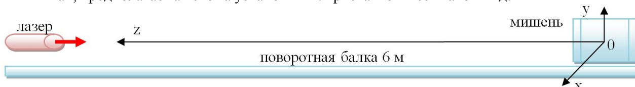
Рис.5 Схема экспериментальной установки В.Приставко. Лазер и мишень жестко закреплены на деревянной поворотной балке.
