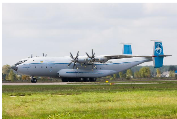
Самолет АН-22. Вес 205 т., нагрузка 60 т., 68 шт.
