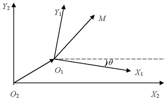
FIGURE 4.1 – Modèle de Helmert
