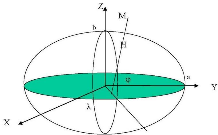
FIGURE 1.2 – Ellipsoïde Terrestre de révolution
