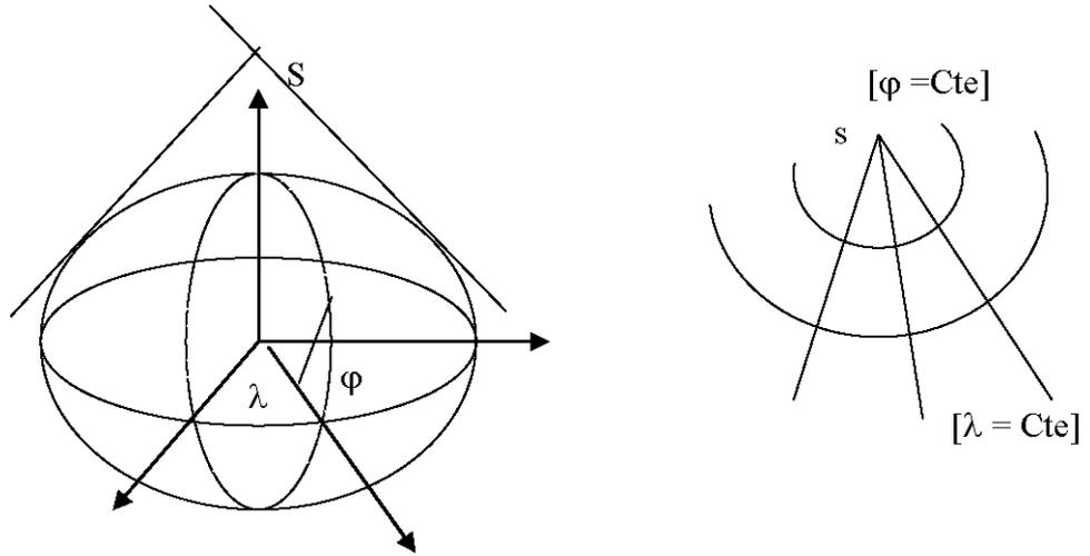
FIGURE 3.1 – représentation géométrique de la représentation Lambert
