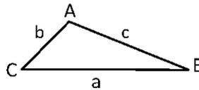
FIGURE 2.4 – Le calcul d'un côté dans un triangle quelconque
