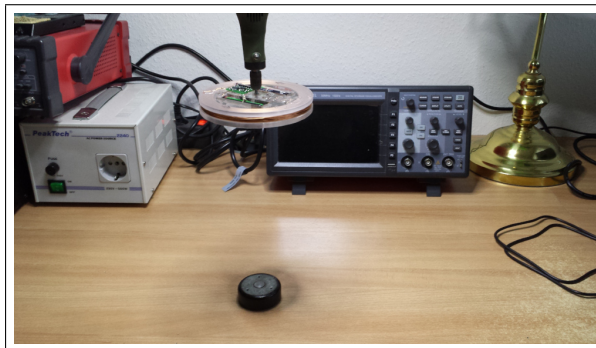
Abbildung 3.14: Messung der Kraft zwischen dem Strom in der Spule und dem 20cm darunter befindlichen Dauermagneten.
