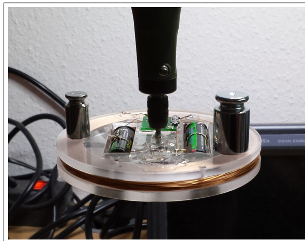
Abbildung 3.12: Kalibrierung mit Prüfgewichten
