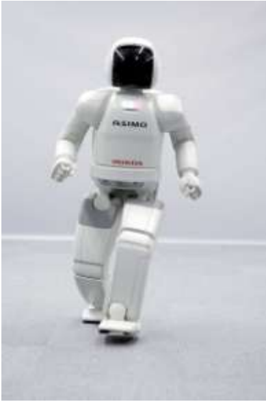
Фиг. 8-4 слева. ASIMO - гуманоидный робот, созданный фирмой Honda. Рост 130 см., вес 54 кг. Робот сделан в форме космонавта и может ходить со скоростью 6 км/час. Сделан Honda's Research & Development Wako Fundamental Technical Research Center in Japan (2003). Япония.
