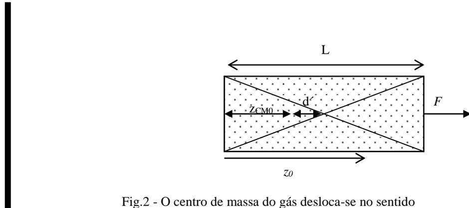
Fig.2 - O centro de massa do gás desloca-se no sentido contrário ao movimento até atingir uma posição de equilíbrio. O centro de massa da caixa que é rígida está fixo em relação às paredes da caixa e coincide com o centro geométrico, dado estarmos a admitir que a distribuição de massa da caixa é uniforme.  $z_{CM0}$  é a ordenada do centro de massa, do conjunto caixa-gás, no referencial da caixa.  $z_0$  é a ordenada no referencial da caixa.
