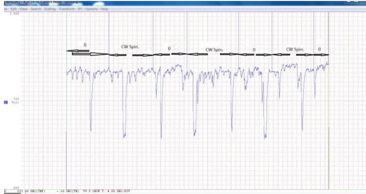
Рис.7. Общий ток аппарата при воздействии вращения по часовой стрелке. Периодические провалы тока - результат работы обратной связи в цепи импульсного источника питания аппарата.
