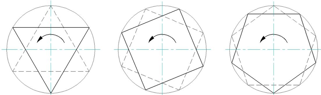
Come ho evidenziato utilizzando un diverso tipo di linea i due poligoni utilizzati pur intersecandosi rimangono ben distinti.
