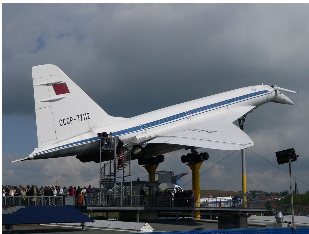
Ту-144 в музее в Зинсхайме , Германия (№ 77112). Длина 65.7 м, размах крыла 28 м, площадь крыла 503 м 2 , нормальная взлетная масса 180 тонн, тяга двигателей 4×НК 144А на взлете 4×20 тонн.
