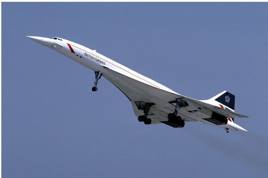
British Airways Concorde G-BOAC. Длина 61.66 м, размах крыла 25.57 м, площадь крыла 358.6 м 2 , нормальная взлетная масса 187.7 тонн, двигатели 4×ТРД. Аэродинамическое качество на M=0.94 K=11.47 , на M=2.04 K=7.14 .
