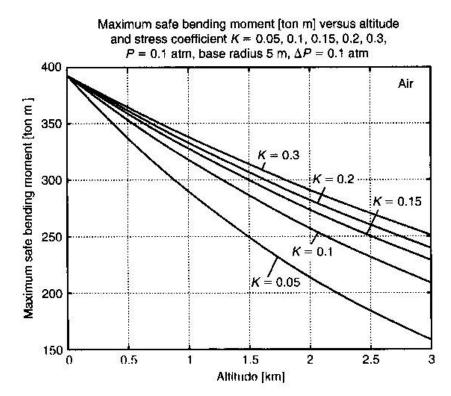
Fig. 4.10. Maximum safe bending moment
