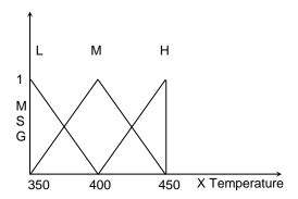
FIGURE 2.3.1: Temperature - input parameter
